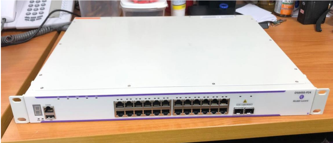
ภาพที่ 4.47 แสดงสลับสัญญาณ Switching ที่จะนำไปติดตั้ง
