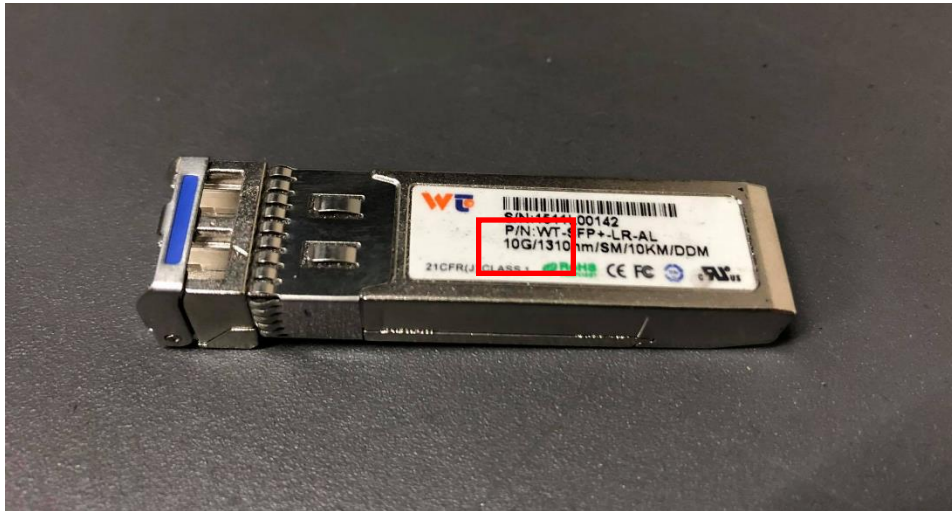
ภาพที่ 4.53 แสดง SFP Module แบบ Single Mode รองรับความเร็วสูงสุด 10 Gbps.
