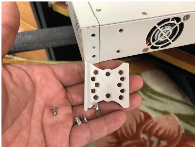
ภาพที่ 4.57 แสดงการติดตั้งหูจับอุปกรณ์สลับสัญญาณ (Switching)
