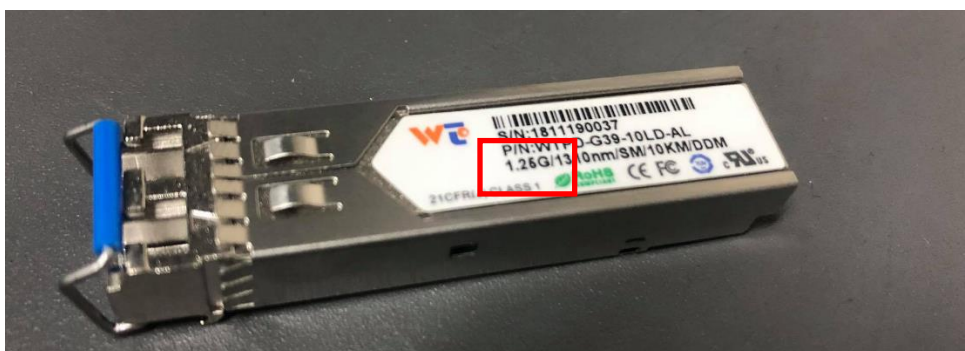
ภาพที่ 4.52 แสดง SFP Module แบบ Single Mode รองรับความเร็วสูงสุด 1.25 Gbps.
