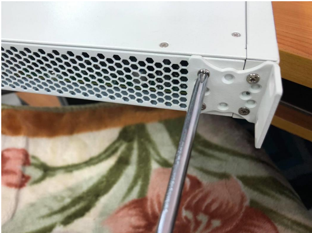
ภาพที่ 4.59 แสดงการติดตั้งหูจับด้านซ้าย
