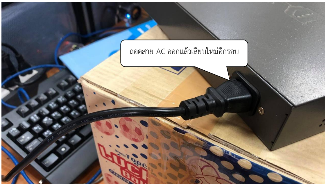
ภาพที่ 4.87 แสดงการถอดปลั๊กอุปกรณ์สลับสัญญาณ (Switching) ออกแล้วเสียบปลั๊กใหม่
